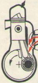
Рис. 3. Вращающийся золотник в цапфе коленчатого вала двигателя «Мото гуцци».
